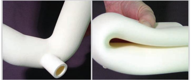
*Sopra*: Parziale immagine di tubo per radiatore realizzato in materiale neutro, non infiltrato, con esempio di drastica sollecitazione alla piegatura senza danni o deformazioni permanenti dello stesso.
